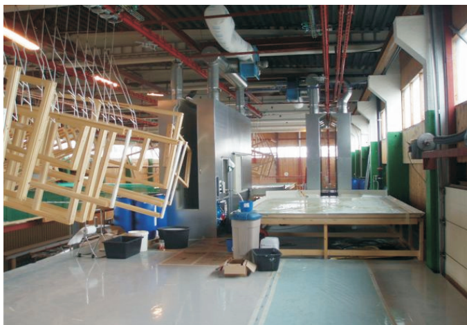
Flow-coat placeret på gulv
